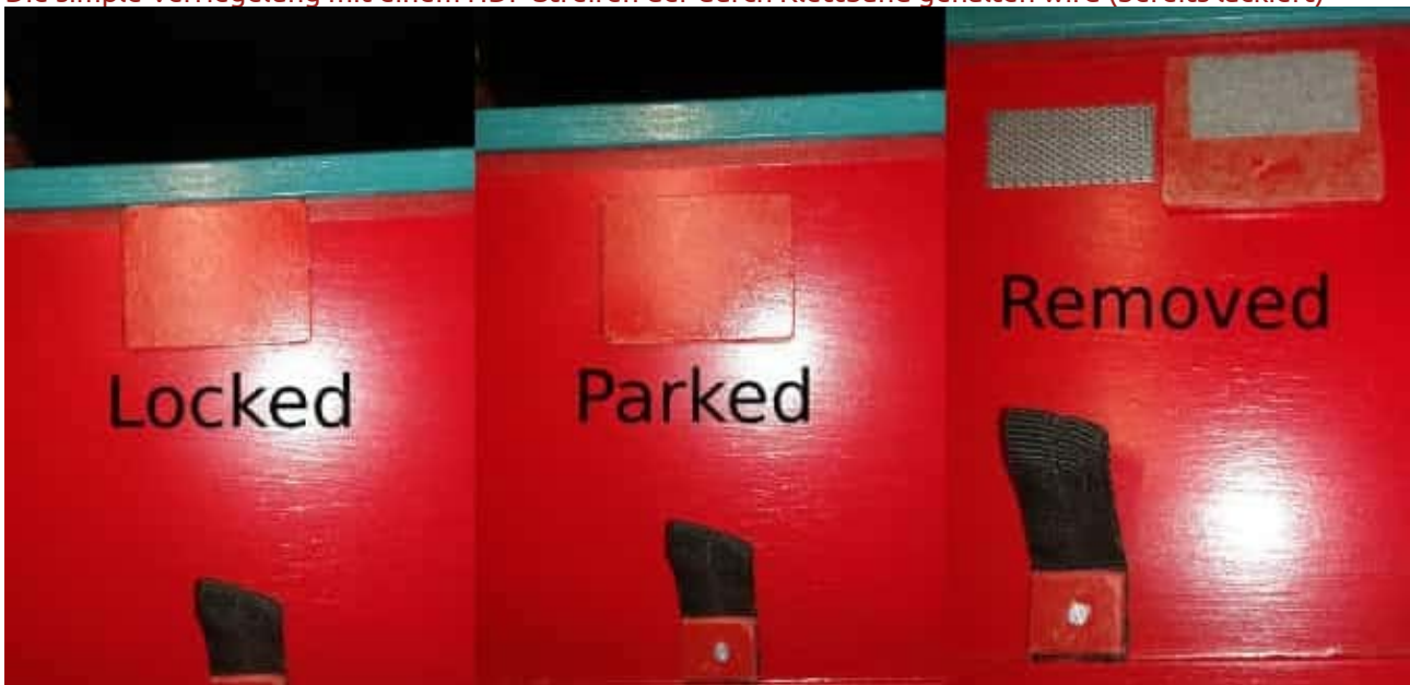
Die simple Verriegelung mit einem HDF-Streifen der durch Klettband gehalten wird (bereits lackiert)
